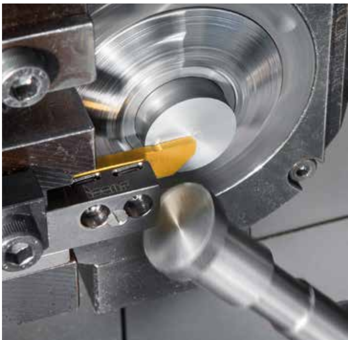
Bild 4 - SWISSCUT XL-verktygen har extra långa skär för större skärdjup vid avstickning och spårsvärning.
